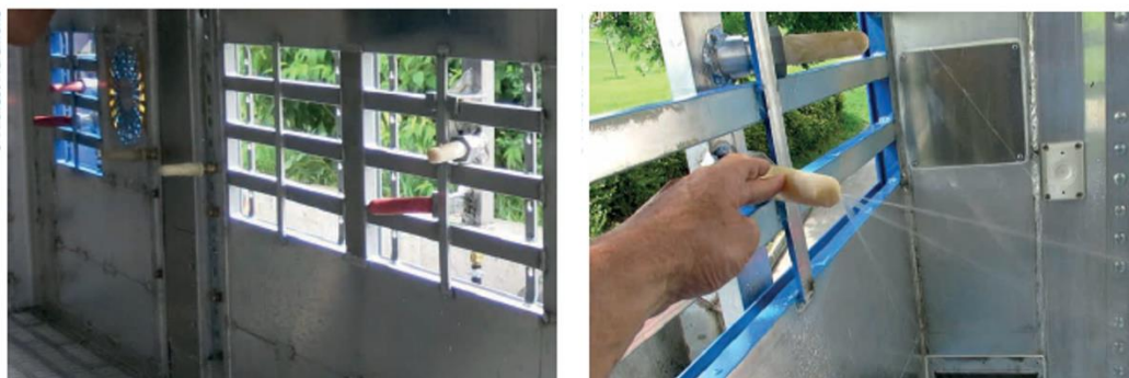
Illustration 4: Foto af drikkenipler påsat gummisutter og illustration af hvordan vandet sprøjter ud ved berøring. Fotografiet er taget af Michael Marahrens, og indgår i rapporten af Rabitsch og Marahrens (2020).
