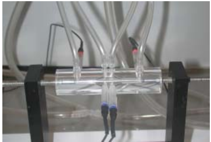
Tarmepitelet er spændt op imellem de 2 halvdele af Ussing-kammeret. 2 elektroder (blå) måler potentialeforskellen over epitelet, og 2 elektroder (rød) måler strømstyrken
