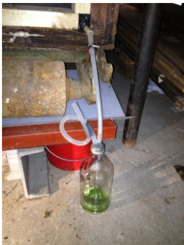
Figur 3 Opsamlingsflasker via slange i hjørne af containere. Borsyre tilsat flasken. Vandlås på gasudslipsslange.
