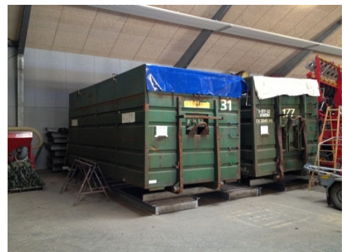
Figur 6 Overdækkede containere, containerpresenning lagt over sort plastik.
