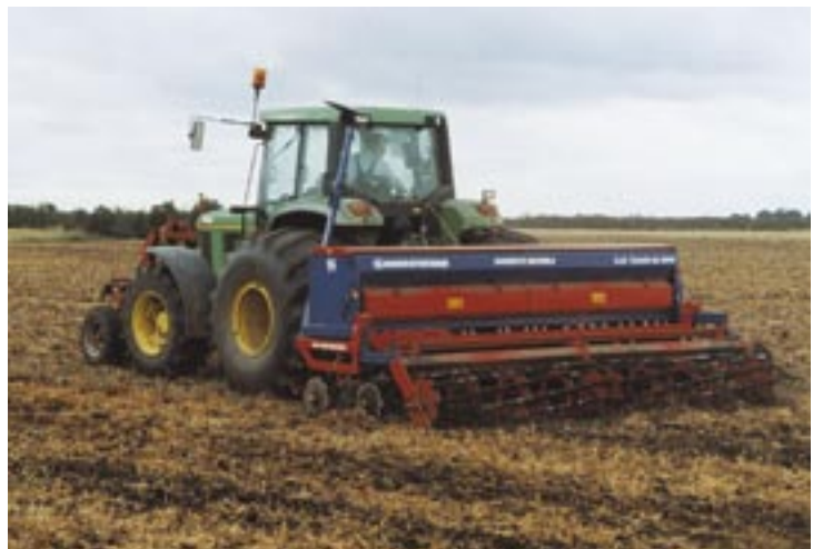
Såning med Kulti-Seeder i harvet stubmark.
