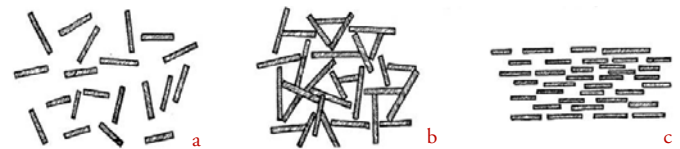
Figur 1. Lerpartikler dispergeret i vand (a), kant-til-kant flokku- leret under indvirkning af organisk stof (b) eller flade mod flade cementeret ved mangel på organisk stof (c).
