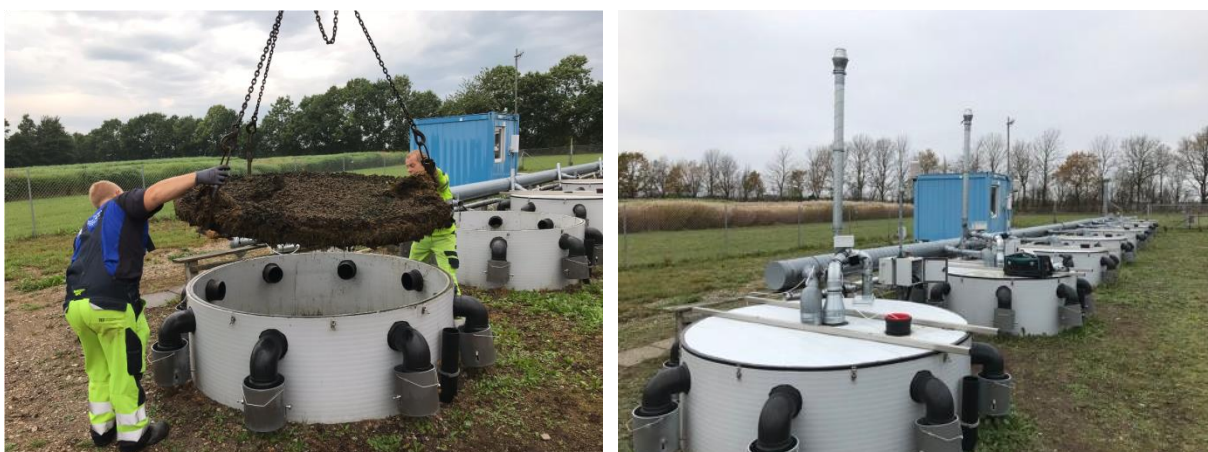
Figur 4. Import af intakt flydelag fra fuldskala-gyllelager (t.v.), og installation af separat ventilation på pilotskala-gyllebeholdere (dybde: 2 m) (t.h., de to nærmeste beholdere).
