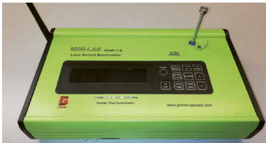
Mini Laser Aerosol Spektrometer brugt til opsamling af svampesporer på løglagre.
