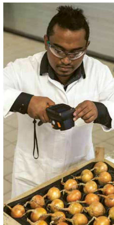
Løgtemperaturen måles med et varmekamera på overfladen af løgene.
